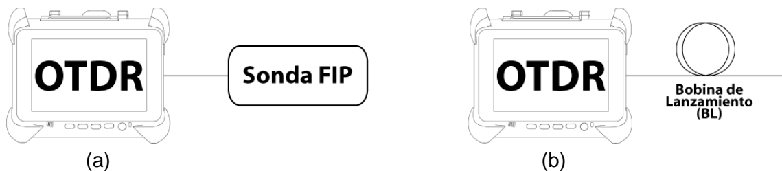
Figura N° 6. Configuración para (a) visualización de estado de limpieza de conectores y (b) visualización del espectro de una traza OTDR de una bobina de lanzamiento.
