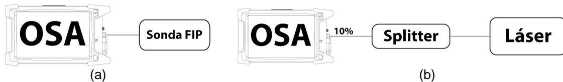
Figura N° 3. Configuración para (a) visualización de estado de limpieza de conectores y (b) visualización del espectro de un láser (transceptor óptico) con un OSA.
