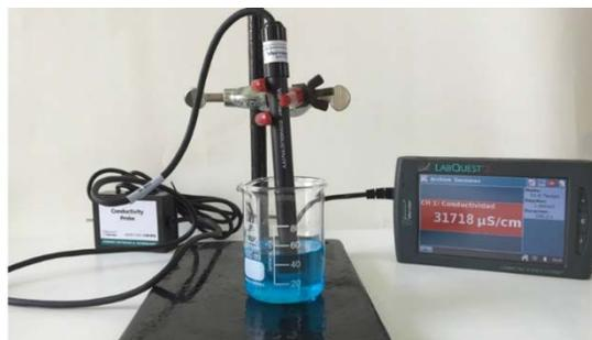
Figura N° 5. Conexión del Equipo con Sonda de Conductividad del Dispositivo Labquest 2
