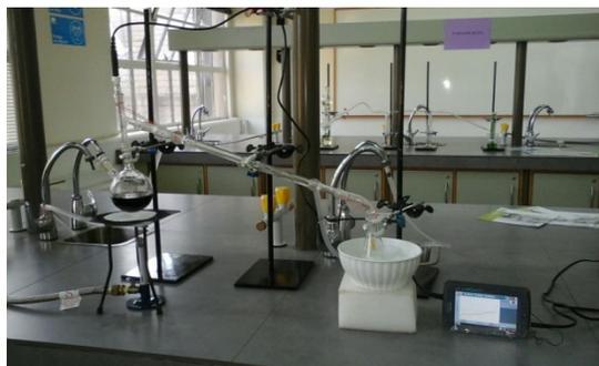
Figura N° 8. Equipo de destilación con Sensor de Temperatura
